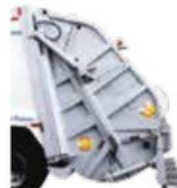
Travessas da tampa traseira inclinadas para maior resistência
